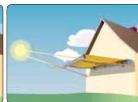
Tiefstehende Sonne z.B. Westfassade
